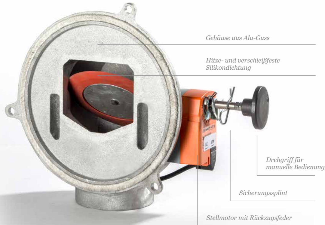
Euromatic – Elektronische Ofensteuerung
